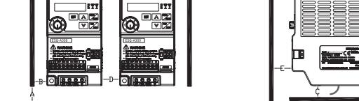
**Конфигурация монтажа одиночного или сдвоенных инверторов**
